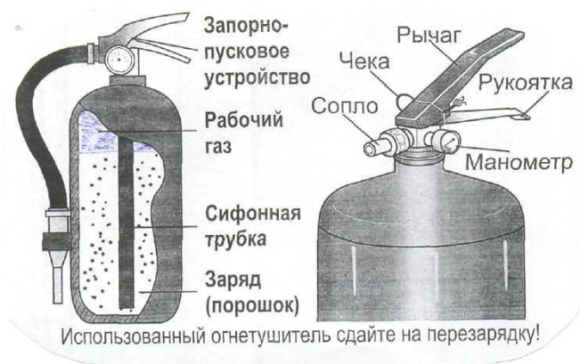
Рисунок 3. Устройство огнетушителя порошкового закачного
